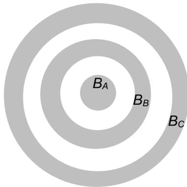
On étudie 3 **conducteurs** sphériques emboîtés.  $B_A$  est une boule pleine,  $B_B$  et  $B_C$  des boules creuses.  $B_A$  porte la charge  $Q$  (positive).  $B_B$  n'est pas chargée et  $B_C$  porte la charge  $Q$ . Déterminer la répartition des charges électriques au sein de ce système, c'est-à-dire leur localisation et leurs valeurs (on pourra répondre à l'aide d'un schéma).
